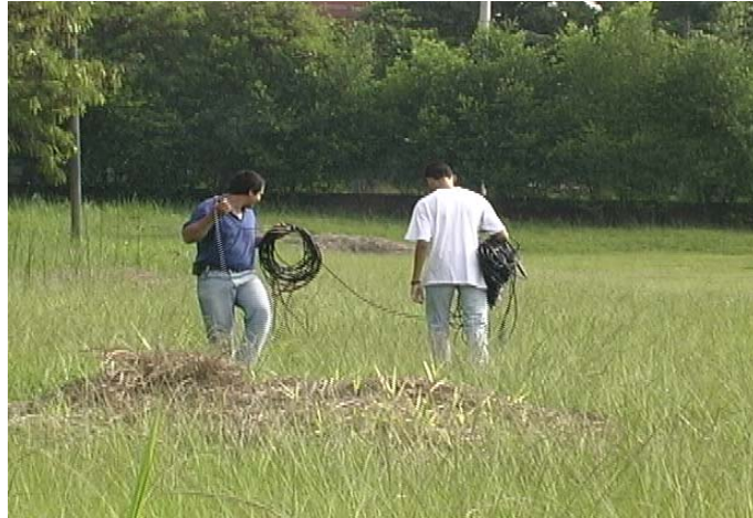
Figura 49. Cables sísmicos durante el tendido de la línea de refracción.
